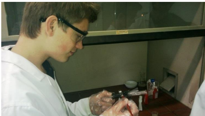
Schüler beim Bestreichen des Kohlefaserschlauches mit Epoxidharz.
