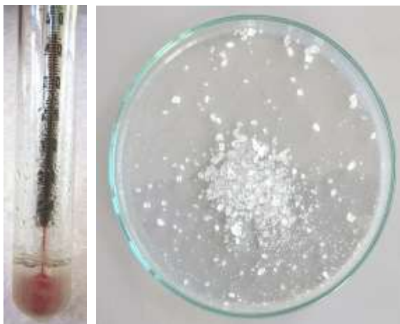
Abb. 1 u. 2: \text{Na}_2\text{S}_2\text{O}_3 \times 5 \text{H}_2\text{O} während des Schmelzens und Impfkristalle.
