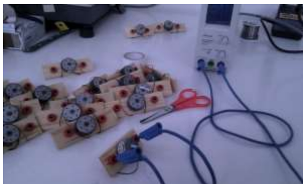
Abbildung 4: Auf Holzplatten montierte Elektromotoren RF300C inklusive Anschlussstecker.
