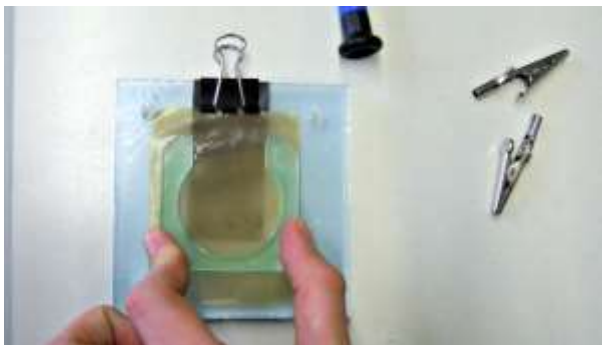
Abbildung 7: Das Carbonvlies muss die Kammer möglichst vollständig ausfüllen. Die kationenpermeable Membran darf gerne etwas größer sein für eine hohe Dichtigkeit.
