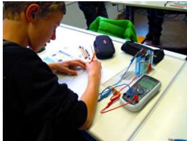
Abbildung 12: Während des Aufladens des Kondensators erstellen die Schüler einerseits eine Wertetabelle und andererseits ein Protokoll für eine spätere Postergestaltung.
